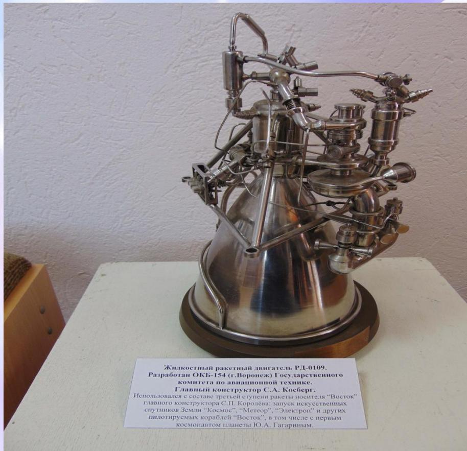
*Рис.3. Жидкостный ракетный двигатель РД-0109. Главный конструктор
